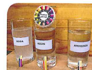
Met lakmoespapier kan de zuurgraad (pH) worden vastgesteld.
